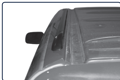
Podélný střešní nosič se instaluje na vnější stranu prolisu střechy vozu.
